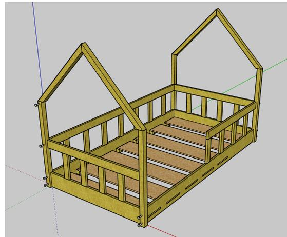
Luego, pon el travesaño de la base, usando los tornillos Allen en la cajita.
