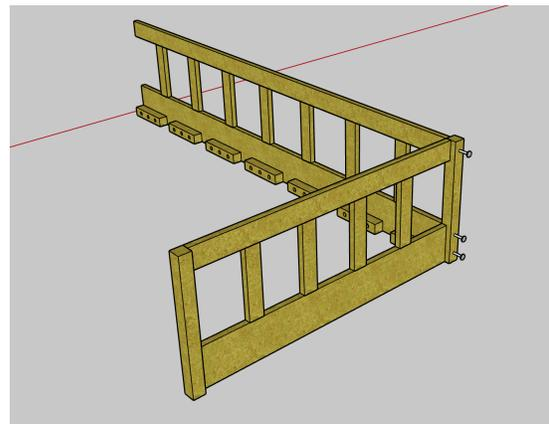
Luego, toma el otro costado (el que tiene el barandal), y repite la misma operación con los tornillos.
